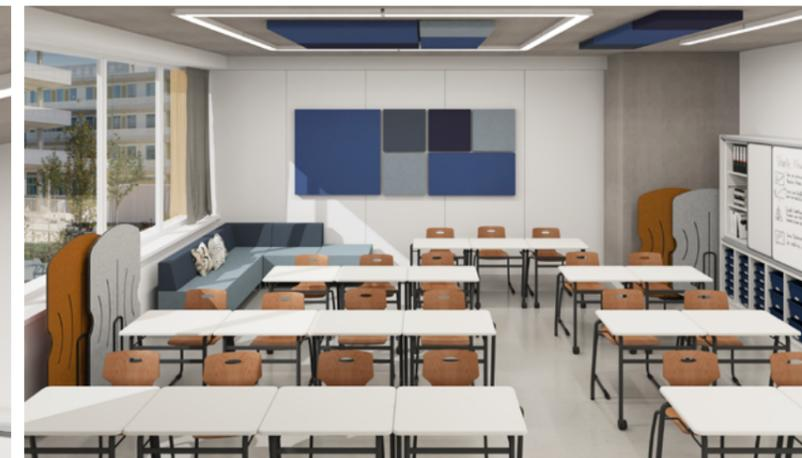
Die leichten Akustiktrennwände ermöglichen den raschen Wechsel zwischen frontalen und kollaborativen Lernformen. Dabei bilden die Wand- und Deckenelemente eine Konstante für angenehme Raumakustik.
